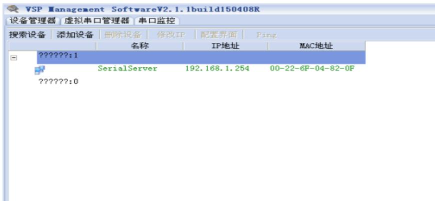
此处的 IP 地址为信号机网络监控器默认的 IP，注意要将计算机的 IP 改成一样的 IP 段，才能对设备进行配置。
